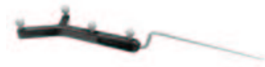
Abbildung 8: Reflektoren eines passiven optischen Systems
